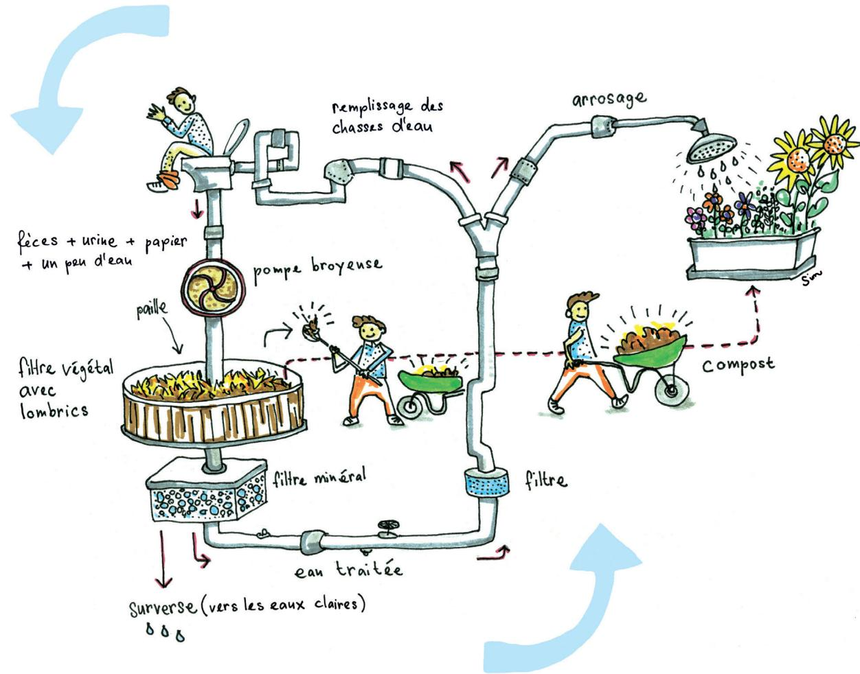
Cette station d'épuration enterrée de 80 m<sup>2</sup> et 3 m de profond se situe dans le jardin sous une plateforme en bois. Elle traite l'ensemble des eaux usées du bâtiment. La matière organique est transformée en engrais par lombricompostage et l'eau ainsi épurée est récupérée dans une cuve de 26'000 litres permettant d'alimenter les chasses d'eau et l'arrosage. Photo: Annik Wetter
