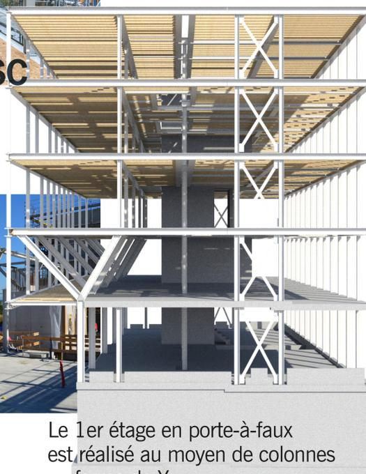
Le 1er étage en porte-à-faux est réalisé au moyen de colonnes en forme de Y
